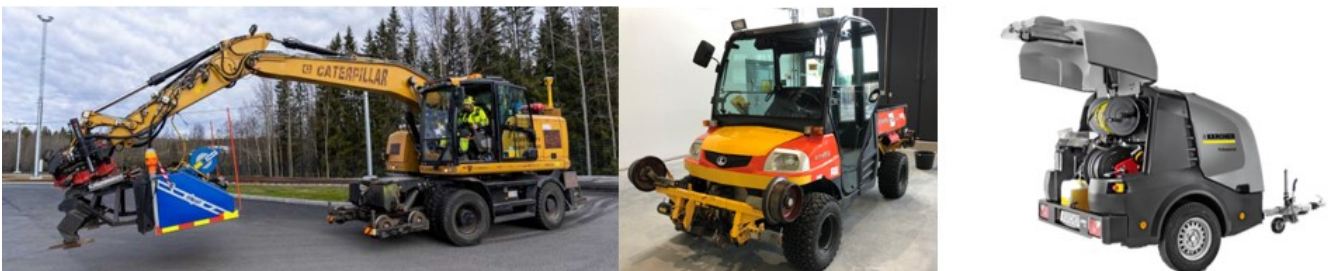
Kuva 11. Kiskopyöräkaivinkone, Kubota ja pesustraileri.
