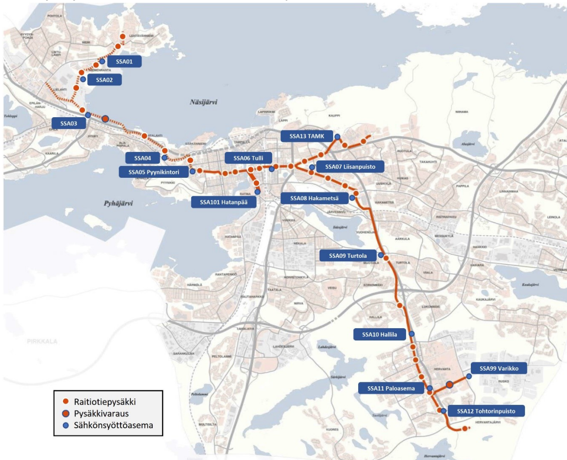
Kuva 8. Rataverkon sähkösyöttöasemat kartalla.
