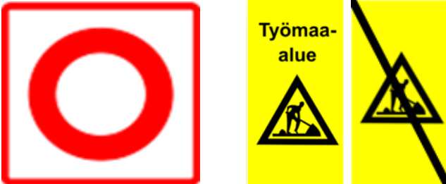
Kuva 17. Merkki 143 seislevy sekä työmaa alkaa ja työmaa päättyy merkit 302 ja 303.
