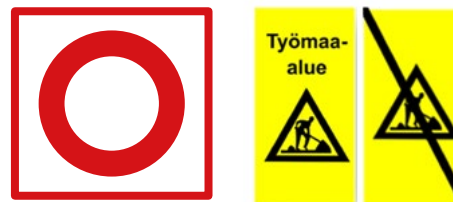
Kuva 17. Merkki 143 seislevy sekä työmaa alkaa ja työmaa päättyy merkit 302 ja 303.
